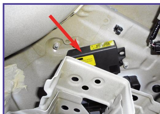
**SEGNALATORE ACUSTICO :** Fissare il segnalatore acustico (buzzer) dietro alla copertura montante posteriore lato guida. Per il fissaggio, utilizzare il velcro in dotazione.
