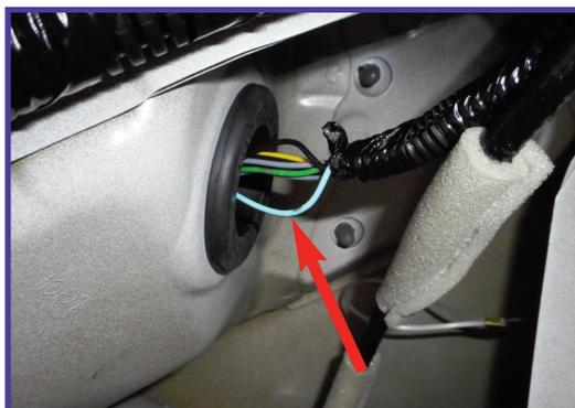
**NEGATIVO:** Per il collegamento elettrico collegarsi alla diramazione di massa originale situata dietro la copertura baule lato guida.
